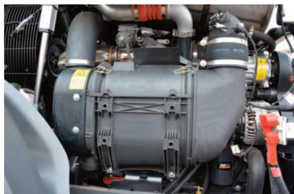
**MAXI FILTRO ARIA** Il filtro aria a cartuccia a valle del prefiltro ciclonico è lo stesso della 1021G e include un estrattore di polvere per depressione (effetto Venturi).
