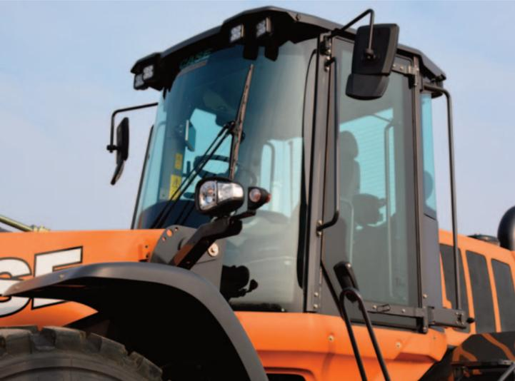
**È SICURA** L'attenzione per la sicurezza è evidente, al di là della certificazione Rops Fops. Apprezziamo i mancorrenti, la scaletta ben inclinata, gli specchi esterni doppi e convessi, i 6 fari a led di serie e soprattutto il parabrezza integrale (sostituirlo costa come quello in 3 pezzi della Serie F).
