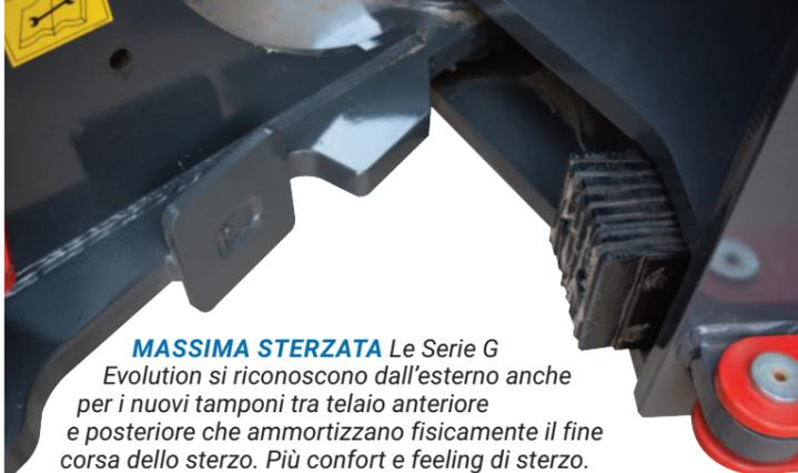
**MASSIMA STERZATA** Le Serie G Evolution si riconoscono dall'esterno anche per i nuovi tamponi tra telaio anteriore e posteriore che ammortizzano fisicamente il fine corsa dello sterzo. Più confort e feeling di sterzo.
