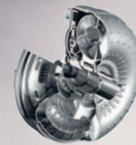
**LOCK-UP** È una frizione interna al convertitore di coppia che annulla le perdite di giri tra motore e trasmissione. Quando si inserisce il lock-up, l'olio del convertitore si raffredda e la macchina consuma meno carburante.
