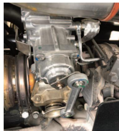
**VALVOLA ALLO SCARICO** Questa valvola parzializza i gas caldi in uscita dal turbo per gestire la temperatura di post trattamento. Nessun fermo macchina e nessuna manutenzione.
